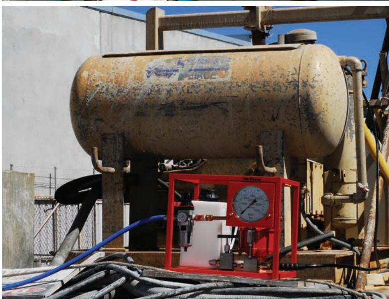
**MHP | BOMBAS MANUALES PARA PRUEBAS HIDROSTÁTICAS**
