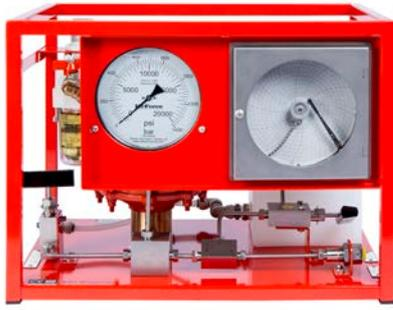
Presiones de salida de hasta 2931 bar
