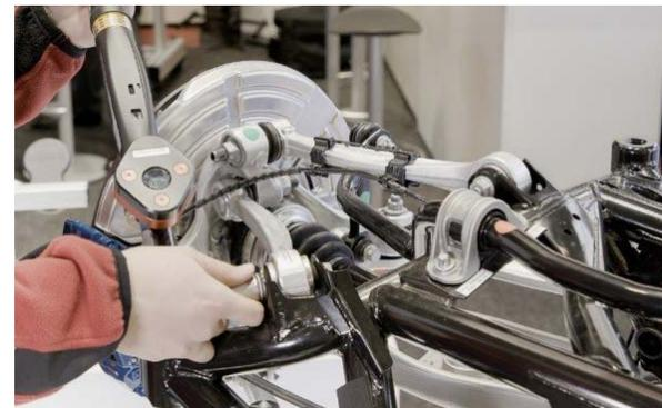
Aseguramiento de la calidad del ajuste del eje mediante el control y la documentación de la posición de la llave dinamométrica. | BMW AG
