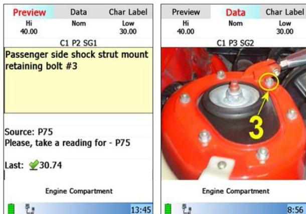
**El colector de datos portátil ASI DATAMYTE 600 reduce significativamente los errores y el tiempo de aprendizaje de los operarios con detalladas instrucciones y gráficos de alta resolución.**
