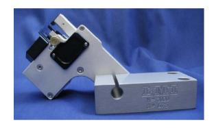
El transductor LMI incorpora una tecnología patentada por LMI™ que permite tomar la medida simultánea de la holgura y el enrase en un punto, lo que reduce el tiempo de comprobación de estas características en más de un 50%. El medidor se ajusta fácilmente sobre la/s pieza/s o montaje y proporciona medidas de gran precisión y repetibilidad.
