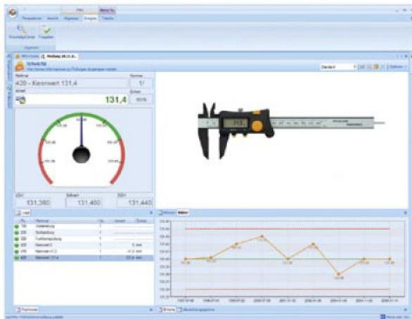
iqs PMV sorgt für einen schnellen Überblick über alle einsetzbaren Prüfmittel und bestimmt die Prüfmittelfähigkeit.
