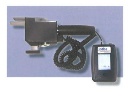
El revestimiento plástico de los dedos, proporciona una protección que evita que el operario o el sensor se arañen. El asa puede acoplarse en 2 posiciones distintas para su óptimo uso en distintas localizaciones como la puerta del maletero o el techo corredizo. El sistema capturará el máximo (pico) de fuerza creada por la ventanilla automática antes de que el seguro invierta el movimiento.
