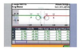
\*Modelo de dispositivo – El controlador LG5000 proporciona todas las mediciones y algoritmos de análisis Laser Gauge, incluyendo dispositivos virtuales, algoritmos básicos LG, programas para piezas o productos, y compatibilidad con CAD. Los escaneos se guardan para cada medición tomada y pueden ser revisados simplemente seleccionando las filas de datos. Los ajustes en los algoritmos pueden ser modificados y ejecutados sobre los escaneos en la tabla de datos para evaluar el impacto del cambio.
