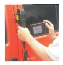
\*Características avanzadas – Dispone de un gran contraste de escaneo para su uso con distintos colores de superficie. La pantalla de rotación de cuatro direcciones permite su uso con cualquier mano y la batería intercambiable en caliente permite su uso ininterrumpido.
