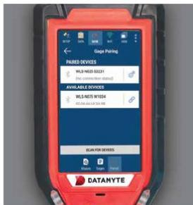
Comunicación Bluetooth sin fisuras con llaves dinamométricas Lightstar™ ASIDataMyte
