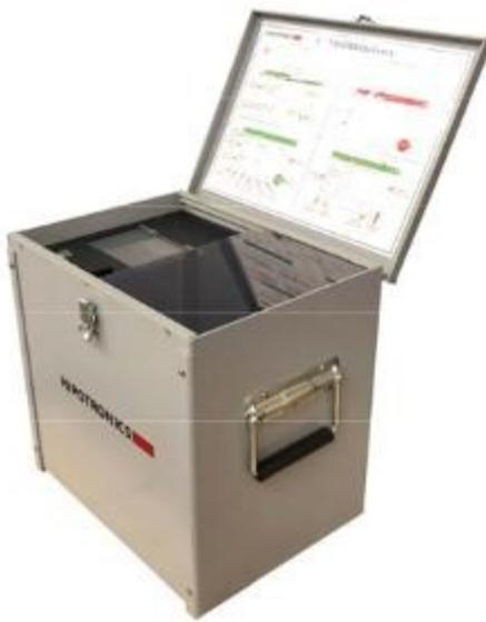
El instrumento OC-60 DI realiza el ensayo de aislamiento en aislante líquidos usados en una gran variedad de equipos eléctricos. Por su diseño robusto, ligero y portátil, asegura una larga vida de trabajo con seguridad tanto en campo como en el laboratorio.
