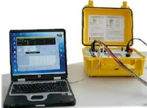
El software APSW incluido con el TTR 2796, posibilita la configuración y control por el puerto USB. Se puede añadir el software de análisis avanzado, personalizado para cada cliente con gráficos, tendencias y generación de informes. Las medidas pre-capturadas así como los datos on-line, pueden ser analizados, guardados, y recuperados.
