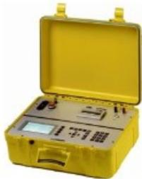
Sistema portátil para el diagnóstico no destructivo del estado del aislamiento del papel-aceite (efecto del contenido de humedad y envejecimiento) usando el método de recuperación de tensión
