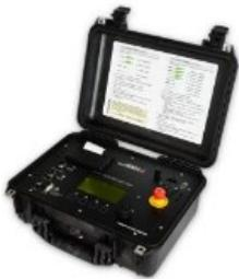
Medida de la relación de espiras y relación de tensión, fase de desplazamiento y corriente de excitación. Identificación automática de la conexión de devanados y detección del grupo vector. Control remoto por USB
