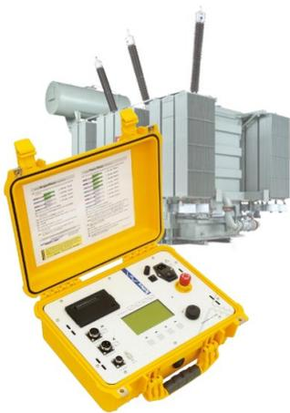
La estrecha colaboración entre los principales fabricantes de transformadores ha dado fruto con la aparición del nuevo medidor de relación de Tettex 2796. El nuevo TTR 2796, combina la movilidad y un manejo fácil e intuitivo, con una precisión superior al 0,03%. La alta tensión de ensayo de 250 V asegura buenos resultados, incluso con los grandes transformadores de potencia.
