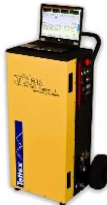
Herramienta ideal para la inspección y mantenimiento periódico de las pérdidas en los aislamientos eléctricos, factor de disipación (tan), factor de potencia y capacidad en transformadores de potencia, de distribución, bornas, motores, generadores, etc.
